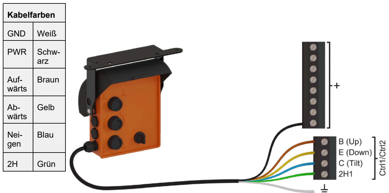
Figure 51 Anschluss von CD3 an ZePRO1
